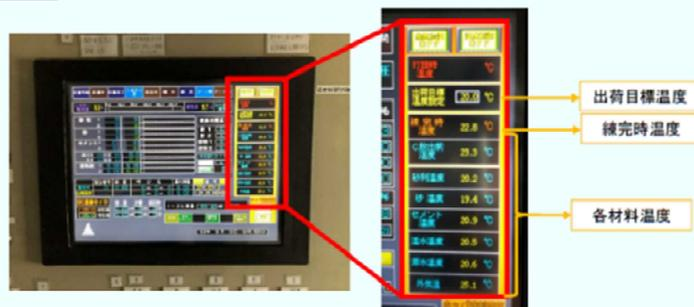
温度制御は、水（原水、温水）、骨材（細・粗骨材）、ならびに、セメントの温度測定、および、混練時における正確なコンクリートの温度測定を基に行われる。得られた温度測定値から、目標線上がり温度に必要な熱容量を計算し、添加する温水の温度を自動調整して目標線上がり温度のコンクリートを製造する。さらに、線上がり完了から吹付け開始までのコンクリート温度の変化を切羽に位置する吹付け機のホッパーで実測し、その結果を次サイクルの目標線上がり温度に反映することで、切羽で最適なコンクリート温度による吹付けを可能としている。
