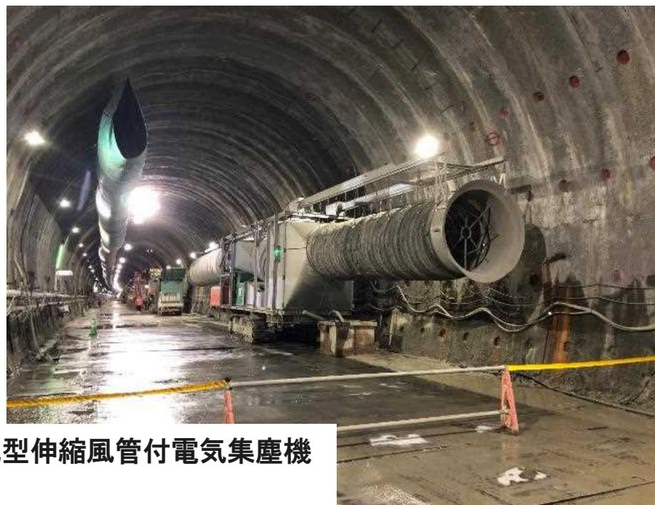
エコクリーンクローラ搭載型伸縮風管付電気集塵機
