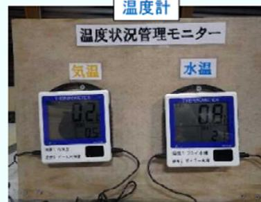
温度状況をいつでも確認できるように温度計を設置しています。測定項目は外気温・ドーム内気温・水槽内水温・ボイラータンク水温。
