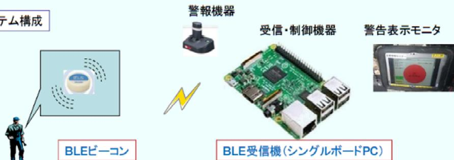
所持したBLEビーコンが電波を発信し、受信機のアンテナで受信
