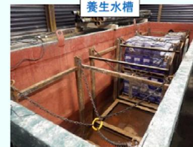
20m<sup>3</sup>水槽を埋め込み、中に温水を張って薬液を中で養生します。最大で8バレット分の薬液を温めることができます。
